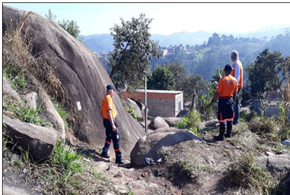
Foto FC-ITA-07-03.02: Vista de um dos blocos de rocha (matacão) de dimensões métricas que ocorrem na área, mas que estão estáveis.
